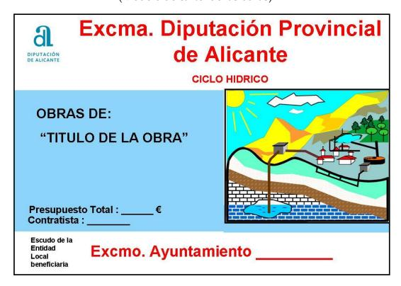
El cartel de las obras tendrá las siguientes dimensiones: 1,50 x 0,95 m². El material será chapa galvanizada y vinilo adhesivo, y estará soportado mediante postes de acero galvanizado de sección rectangular, cimentados con hormigón armado".
