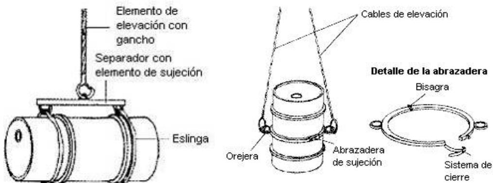
Elevación mediante cables o eslingas
