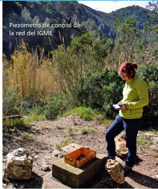
Piezómetro de control de la red del IGME
