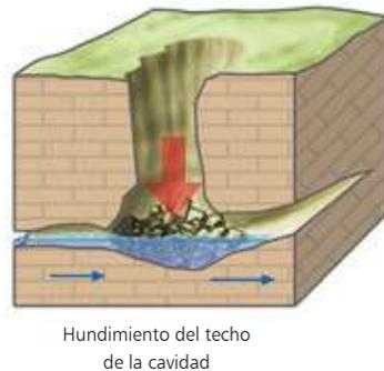
Tipos de dolinas (disolución y colapso). Evolución y formación de simas y avencs: Dolina de colapso de El Forat de Pedreguer.
