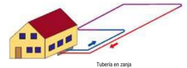
Figura 19. Sistema cerrado con intercambiador de calor horizontal de un bucle. Fuente: Mands, E., Sanner, B. *Shallow Geothermal Energy*. UBeG GbR, Zum Boden 6, D-35580 Wetzlar
